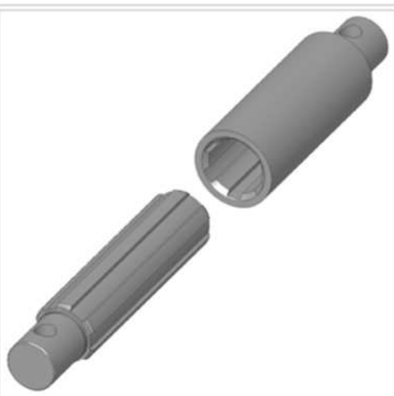
Шлицевой вал и втулка с прямоугольным профилем.
