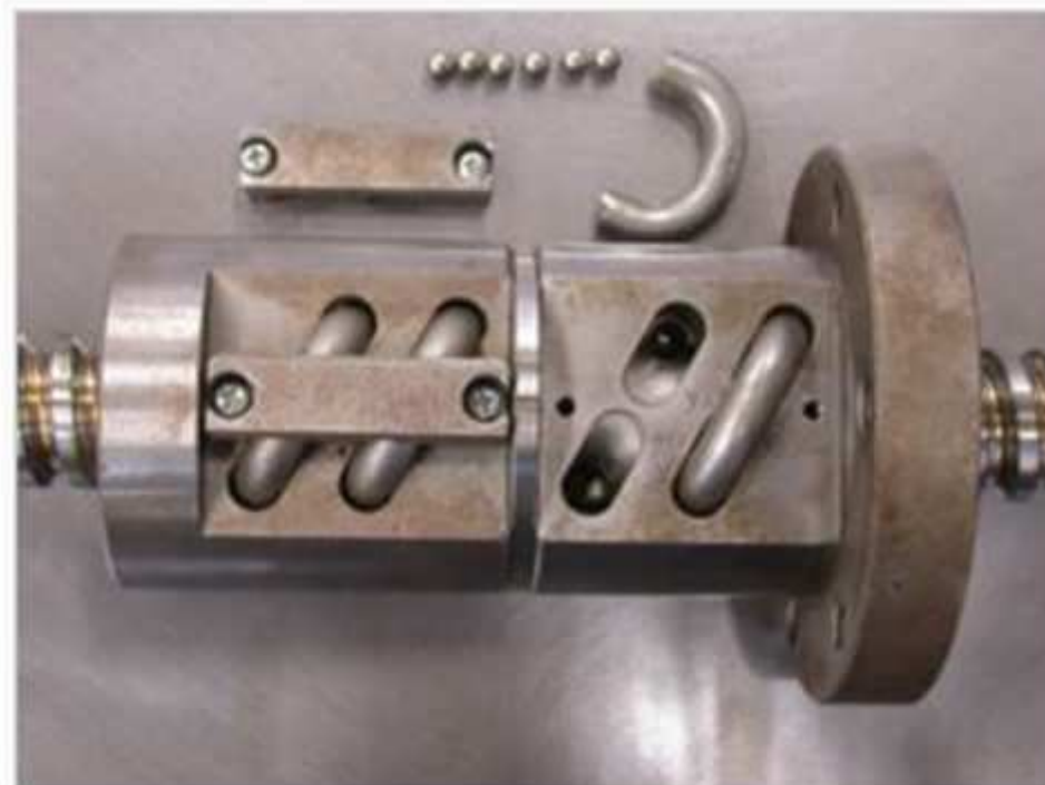
Шариковинтовая передача, с разобранным возвратным каналом
